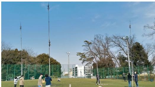
スマートポール同時起動実験の例 = 4台のドローンがホバリングしている環境を再現.
